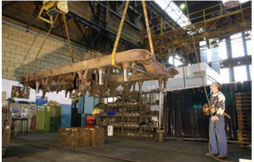
Gedemonteerd draaistel voor een grondige inspectie in Salzinnes, 2004 (Ref. D2373-02)
