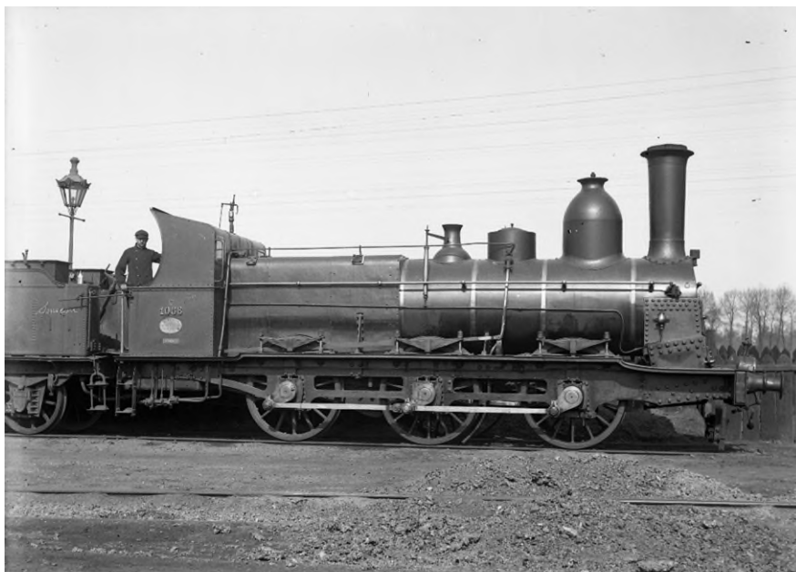
Stoomlocomotief 1038 van de Belgische Staatsspoorwegen voorzien van een afdak van het type 'kuip' (Ref. Q1173)
