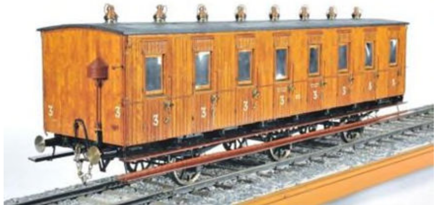
GC-rijtuig (Grande Capacité) waar de treinbegeleiders hun controles uitvoeren via de loopplank die onderaan het rijtuig loopt. (Réf. 2614)
