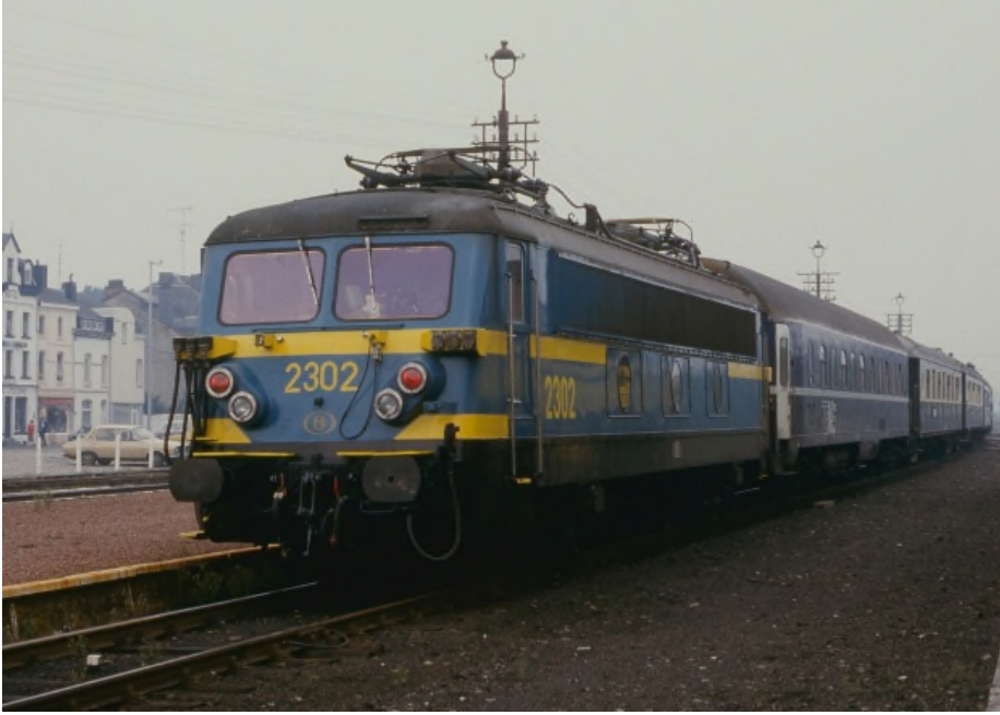
Locomotief 2302 met aangepaste ventilatieroosters, Bertrix, 8 september 1984, Ronald Mardaga (Ref. M076-015)
